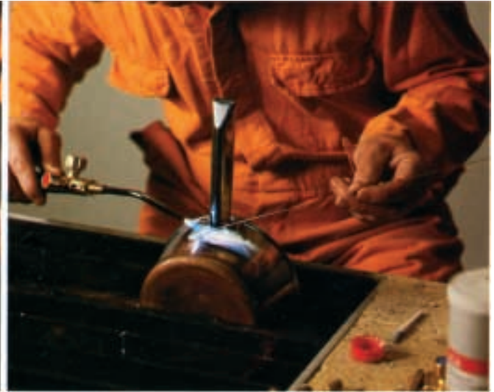
Hartlöten von rostbeständigem Stahl Schweißeinsetzung: 0,2–0,5 mm.
