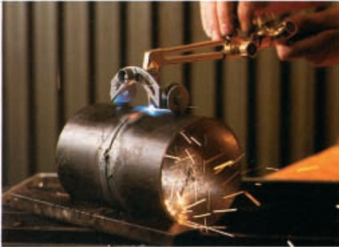
Brennschneiden. Schneiden eines Rohres mit Hilfe des Führungswagens.
