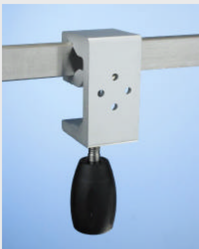
13 Normschienenklaue für verschiedene Normschiene, eloxiert 4 Senkbohrungen für M5 Schrauben Ballgriff, Spannweite bis 40 mm Adaption horizontal und vertikal möglich für z.B. Ablagekorb
